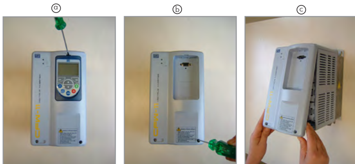
Figura 2 - Remoção da tampa frontal
