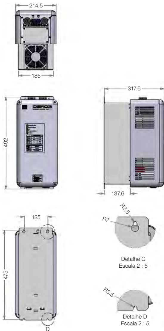
Figura 7.1: Dimensões do DBW03 em mm
