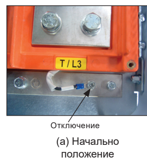
Рис. 21 с (а) до (б): Размеры корпуса F и G с заземлением - расположение и процедура подключения к сети или дельте - переместите фильтр RFI на землю для отключения
