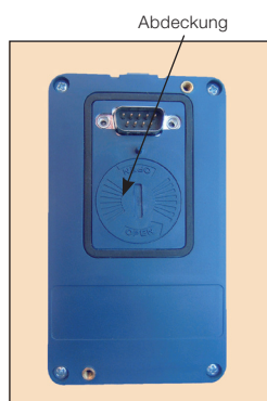
Abb. 31: Batteriefachabdeckung des Bediengeräts
