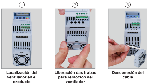
Figura 6.1: Retirada del ventilador del disipador
