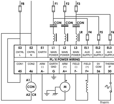
Abbildung 4-9: Schaltplan Stromversorgung
