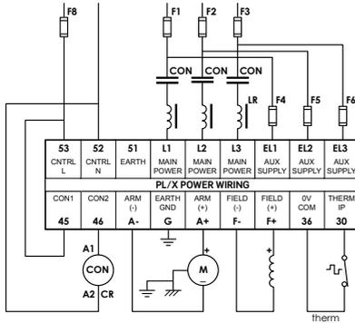
Figura 4-9: Diagrama de cableado de la alimentación
