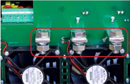
Remarque : Bornes d'excitation (F+ et F-) et bornes d'alimentation EL1, EL2, EL3 identiques à celles du châssis 1.
