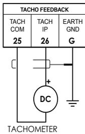
Figura 4-11: Tacómetro CC
