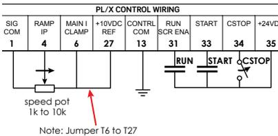
Abbildung 4-10: Schaltplan Steuerung
