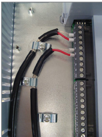
Figura 3: Exemplo de conexão da blindagem dos cabos de controle (nesse caso foi apresentado exemplo de cabos ligados em XC1, mas o mesmo se aplica aos cabos ligados em XC25)
