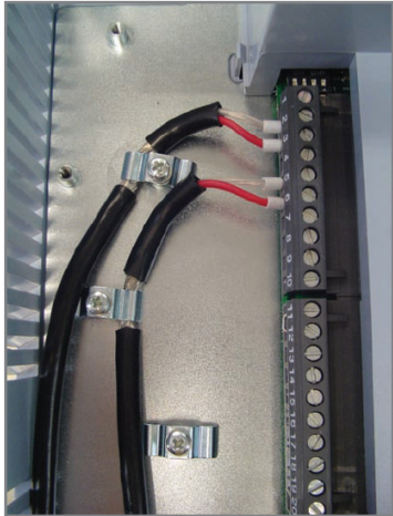
Figura 3: Ejemplo de conexión del blindaje de los cables de control (en ese caso fue presentado el ejemplo de cables conectados en XC1, más el mismo se aplica a los cables conectados en XC25)
