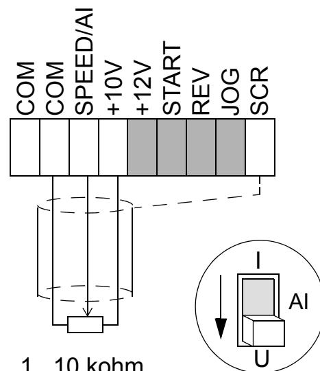
Quando si utilizza il segnale di corrente 0/4...20 mA: - Portare il ponticello AI in posizione "I" = corrente.
