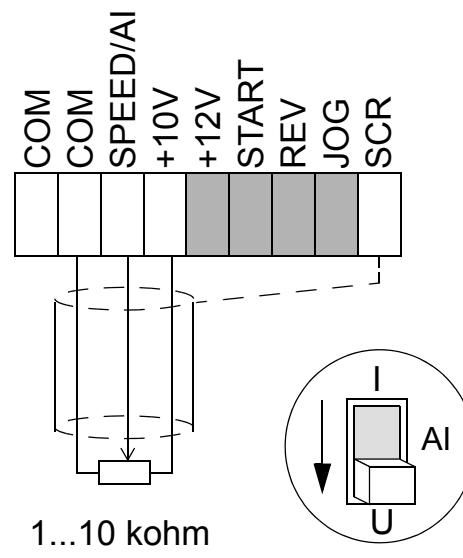
Utilisation du signal en courant 0/4...20 mA : - Basculez le cavalier AI en position courant («l»).
