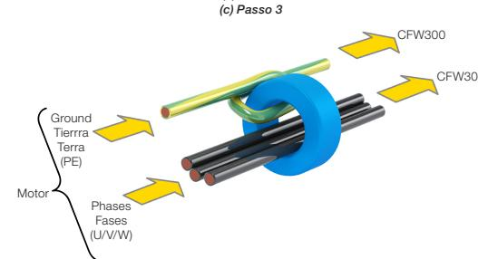
Figure A5: (a) to (d) Common mode choke installation on the motor cables
