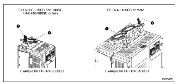
Fig. 8-6: Reinstall the fan cover
