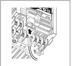
Fig. 3-21: PU connector
