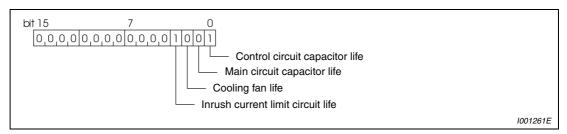
Fig. 6-140: Bits of parameter 255
