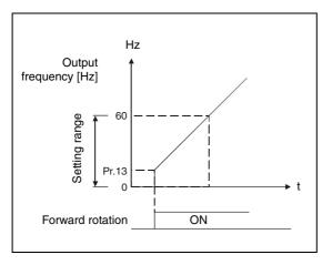
Fig. 6-28: Starting frequency parameter
